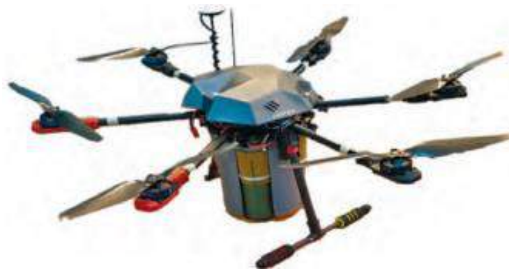
Рис. 2. Минный контейнер револьверного типа, установленный на гексакоптере
